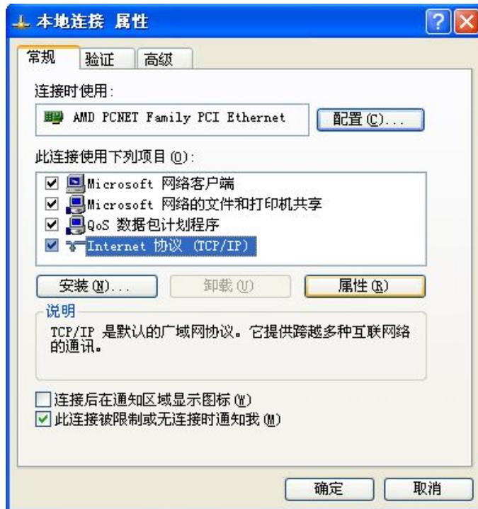
3.1.4 选择自动获得 IP 地址和自动获得 DNS 服务器地址，然后点击确定，关闭 Internet 协议（TCP/IP）属性窗口
