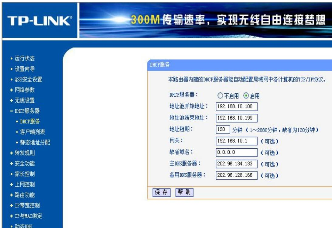
注：还有一种方式就是直接禁用 DHCP 服务器，有个别路由器的 DHCP 服务无法禁用，就只能按上图的方式设置。
